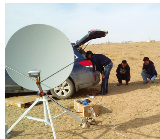
Проведение тестирования мобильного спутникового комплекта Ka-диапазона на границе зоны обслуживания спутника «Экспресс-АМ5»
