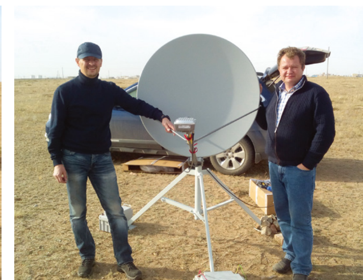
Проведение тестирования мобильного спутникового комплекта Ka-диапазона на границе зоны обслуживания спутника «Экспресс-АМ5»
